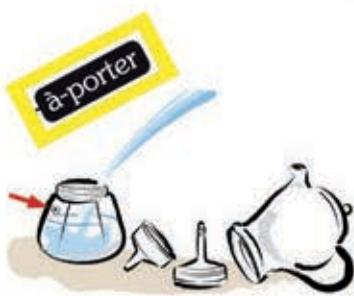
**1.** Riempite con acqua la caldaia fino a metà valvola di sicurezza.
