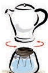
3. Avvitate saldamente la caldaia alla parte superiore in porcellana.
