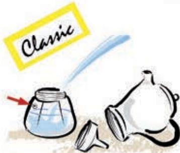
1. Riempite con acqua la caldaia fino a metà valvola di sicurezza.
